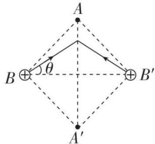
场强最大点与B的连线和B、B'连线的夹角 $\theta$ 的正切值为 $\tan\theta = \frac{\sqrt{2}}{2}$ ，由图可知 $\angle ABB' = 45^\circ$ ，得 $\tan 45^\circ = 1$ ，明显 $\tan 45^\circ > \tan\theta$ ，可知电子是从小于电场强度最大值位置释放，则电子所受的合静电力先增大后减小，再增大最后减小，那么加速度也是先增大后减小，再增大最后减小，而 $v-t$ 图像中图线斜率的绝对值表示加速度大小，所以在运动过程中 $v-t$ 图像中图线斜率的绝对值也先增大后减小，再增大最后减小。故选C。
